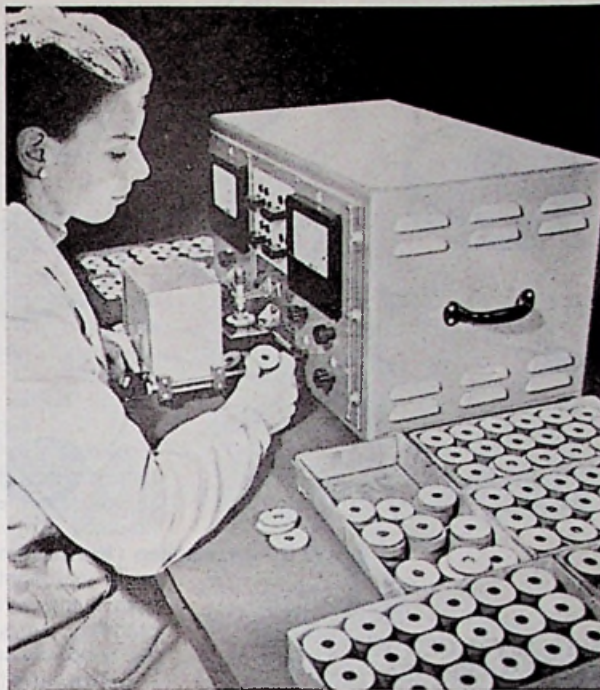
V.D.R.-weerstanden worden voor de aflevering zorgvuldig getest.
